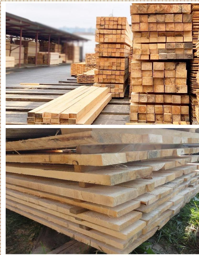
Основной продукцией лесопильного производства являются пиломатериалы, которые вырабатывают при продольной распиловке круглых лесоматериалов (бревен). К дополнительной продукции относят технологическую щепу, которую получают при измельчении кусковых отходов: горбылей, реек и обрезков.
