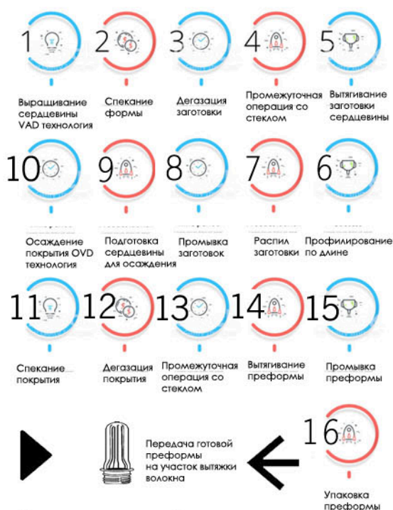
Технологический процесс производства оптического волокна
