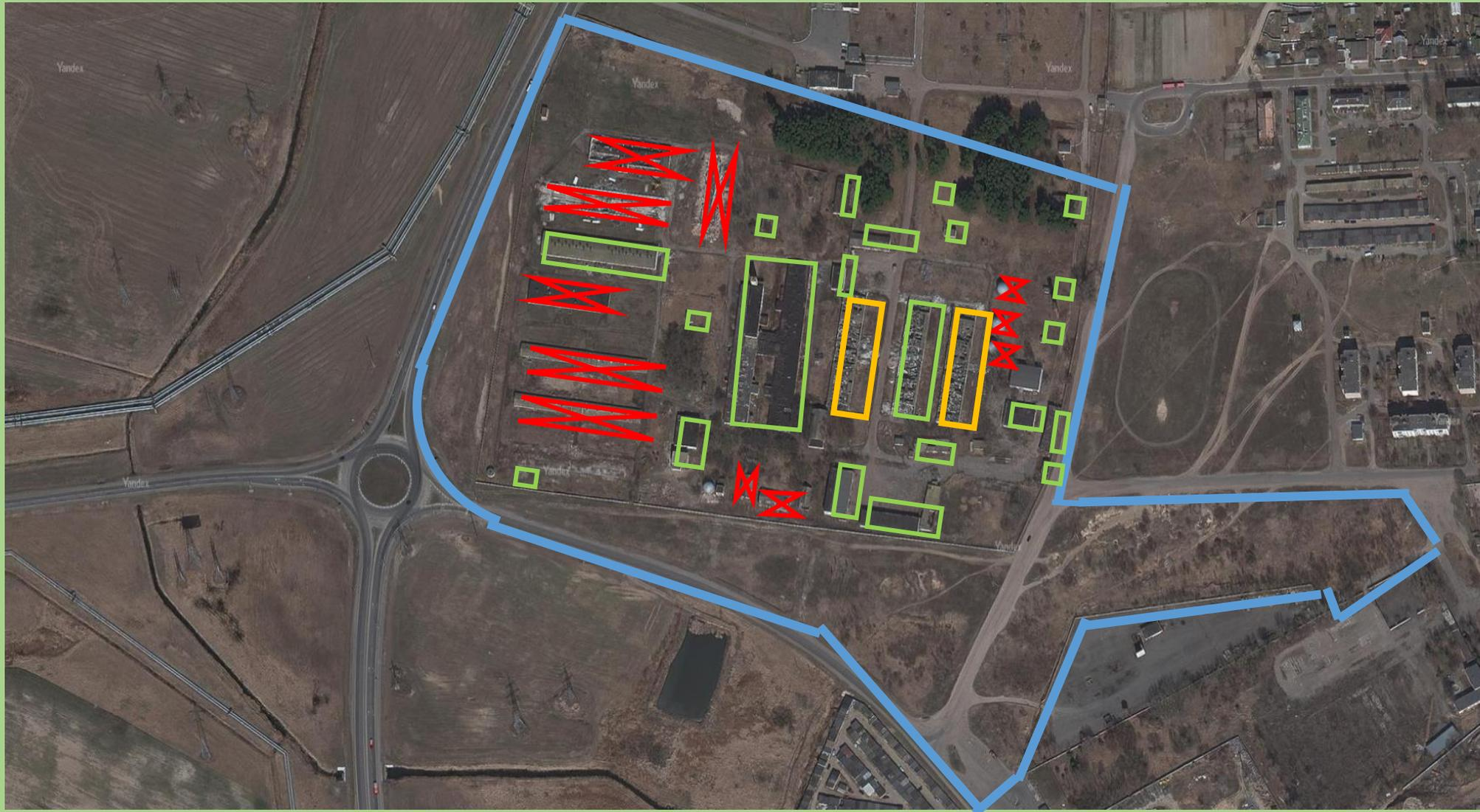
Существующая мощность от сетей ГРЭС по ВЛ-1184 ПС "Центролит". Возможно подключение от сетей ГСРЭС по ВЛ-10кВ №1896 ПС-110/35 "Бардино" со строительством участка ЛЭП-10 кВ протяженностью от 0,8 км и установкой ТП до 160кВа
